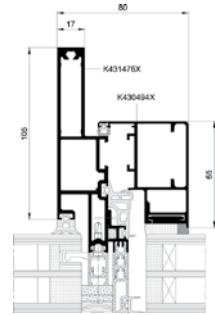
Secțiune montanț-cercevea MB-SR50N IW – varianta EFEKT
